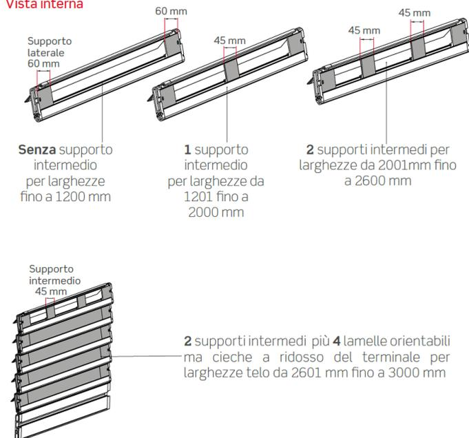
**MINI Orienta: la soluzione ideale per l'installazione con ingombri ridotti.**
